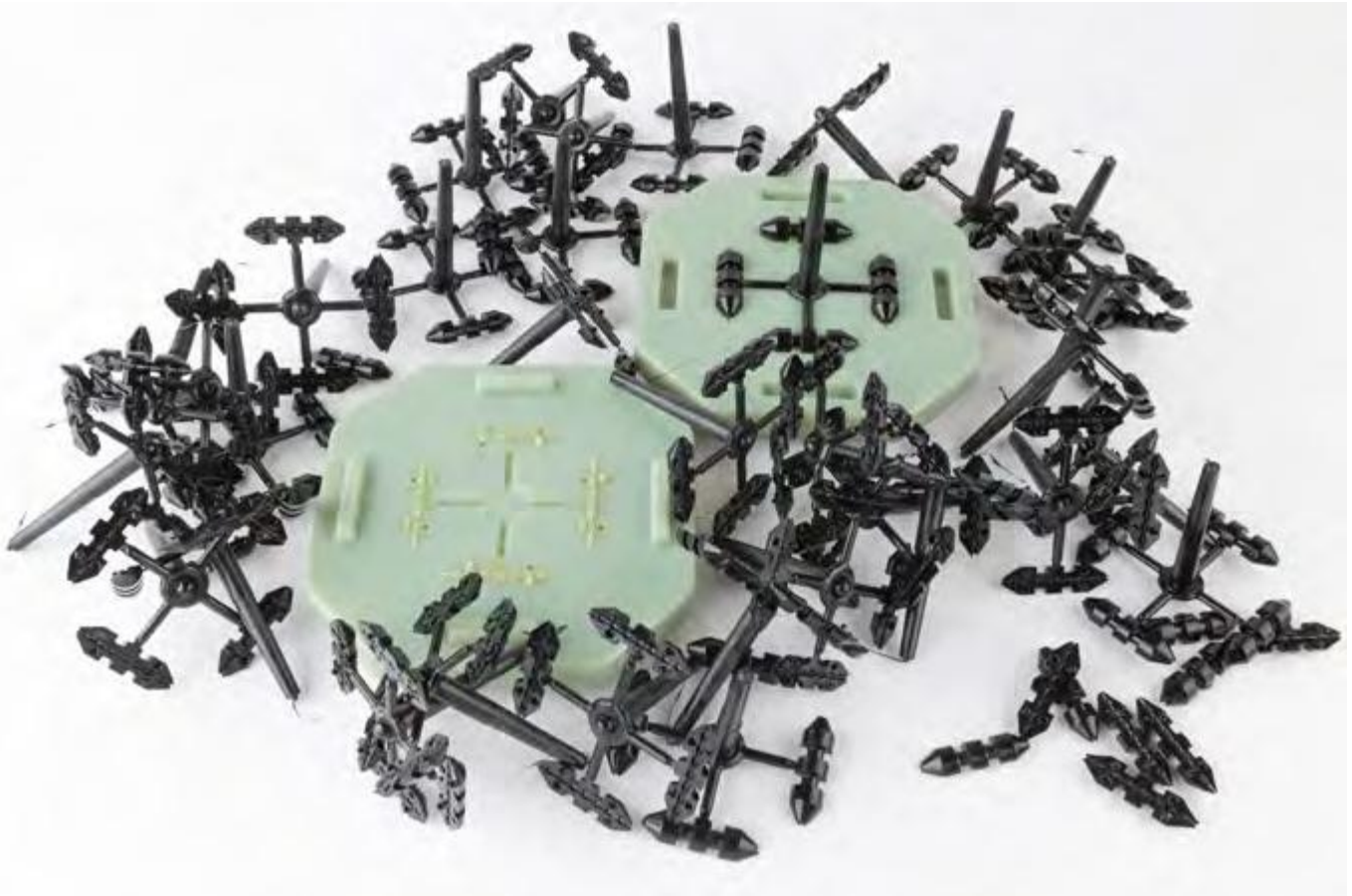
Afhankelijk van het materiaal en de geometrie kunnen tot ook kleine series spuitgietproducten geproduceerd worden met de geprinte matrijs.
