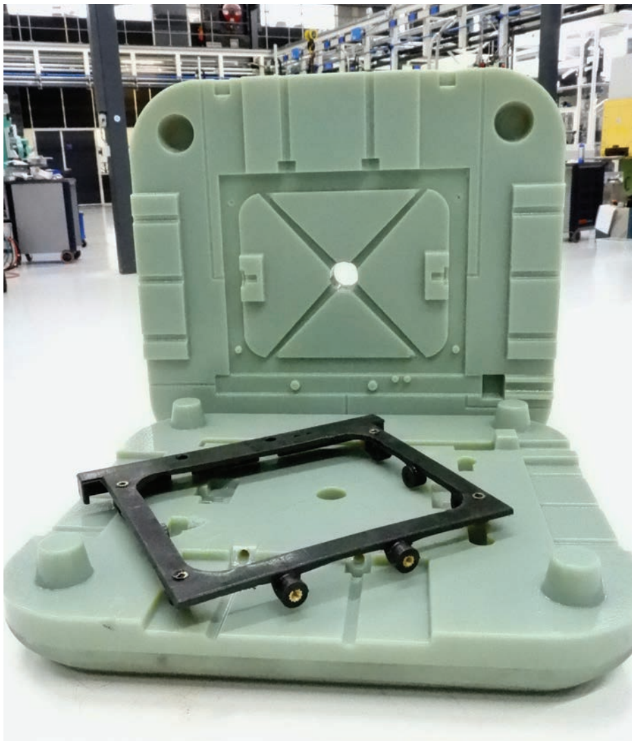
Een 3D-geprinte PRIM-matrijs. Foto: Janneke van Munster-Weebers (Promolding).
